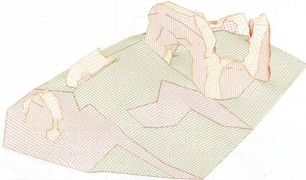
Fig. 3. Representación de superficies irregulares en mallas en el Castillo de Portilla (Álava)
