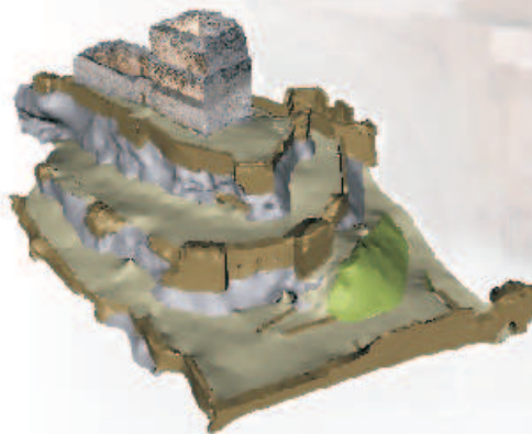
CASTILLO DE LANOS (Ocio, Álava) Modelado mediante mallas y rectificación fotográfica
