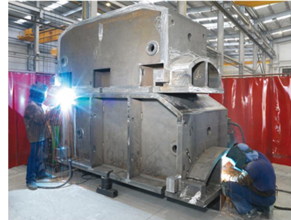
EGONDO, soldadura en elemento estructural para maquinaria pesada
