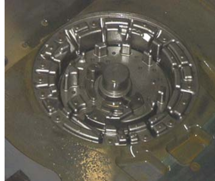
Molde de inyección (izquierda) y electrodo de grafito (derecha) para su fabricación mediante electroerosión
