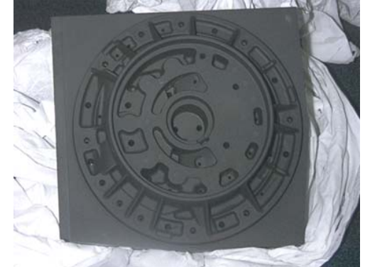
Molde de inyección (izquierda) y electrodo de grafito (derecha) para su fabricación mediante electroerosión
