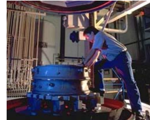
Pieza de turbina de baja presión torneada por ITP S.A.
