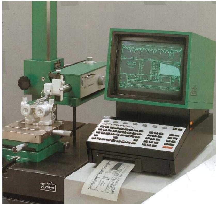
Medición de la rugosidad en el interior de una pieza y de un bloque motor.
