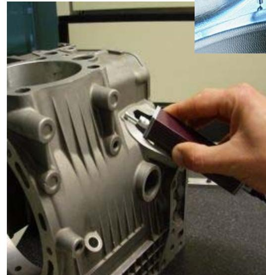
*Muchas empresas que fabrican pieza final necesitan equipos de medición de rugosidad para garantizar las especificaciones: fabricantes de moldes, piezas de automoción, aeronáutica-aeroespaciales,...*
