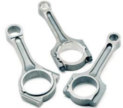
Bielas de automoción fabricadas por sinterizado partiendo de acero en polvo.
