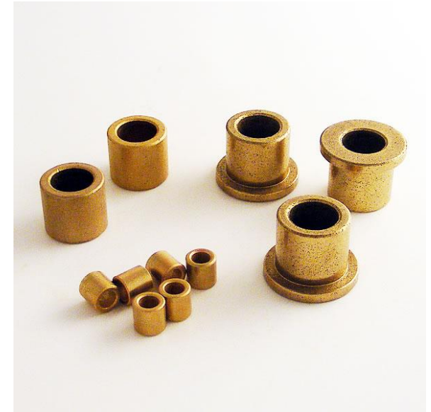
Casquillos de bronce autolubricados: Se sinterizan con una porosidad controlada y posteriormente se impregnan con lubricante
