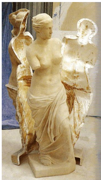
Figura 9. Molde y réplica, ambos en poliéster.
