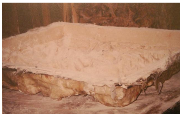
Figura 12. El molde silicona es contenido en el contramolde, sin que este suponga un aumento sustancial de peso.
