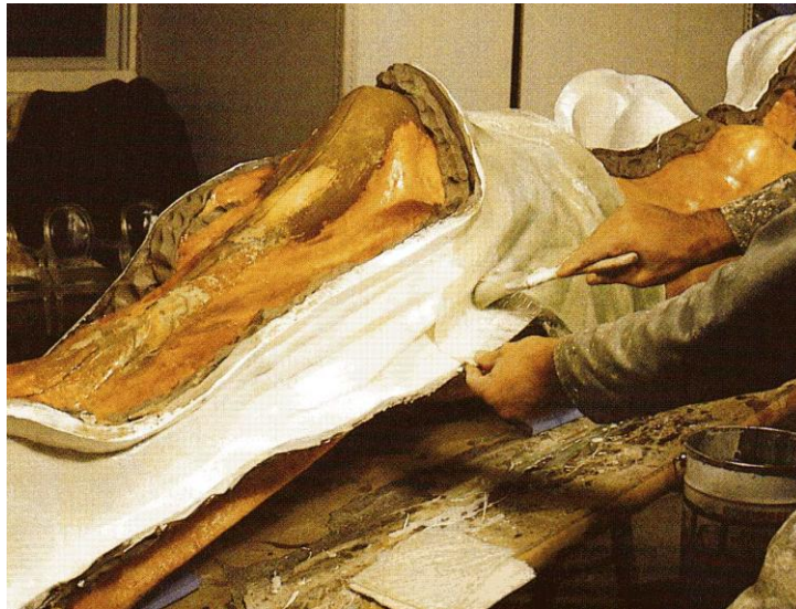
Figura 8. Las piezas del molde se realizan de una en una.
