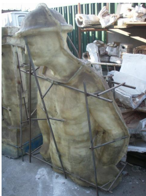
Figura 13. Contramolde de poliéster y fibra de vidrio confeccionado a partir de una escultura de hormigón de 5 metros de altura.
