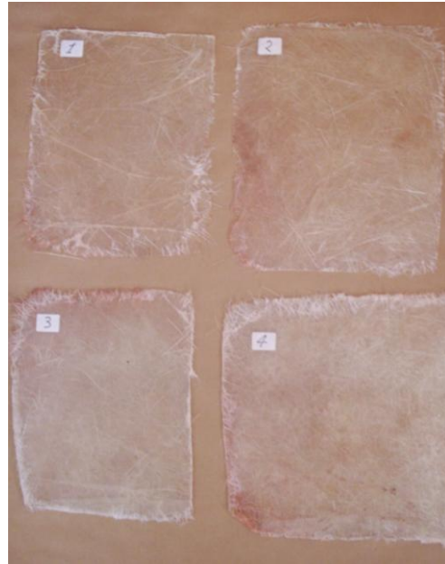
Figura 3. Cuatro muestras de FRP, cada una con un número determinado de estratos de fibra de vidrio.
