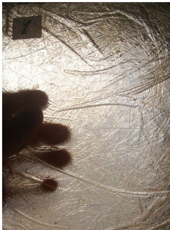
Figura 4. Translucidez perceptible a través de un FRP de poliéster y un estrato de fibra de vidrio.
