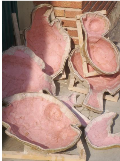
Figura 10. Moldes de poliéster, utilizados para obtener réplicas en cartón fallero.
