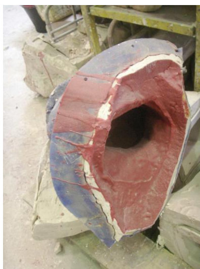
Figura 14. Contramolde de poliéster y fibra de vidrio utilizado en los procesos de fundición artística “a la cera perdida”.
