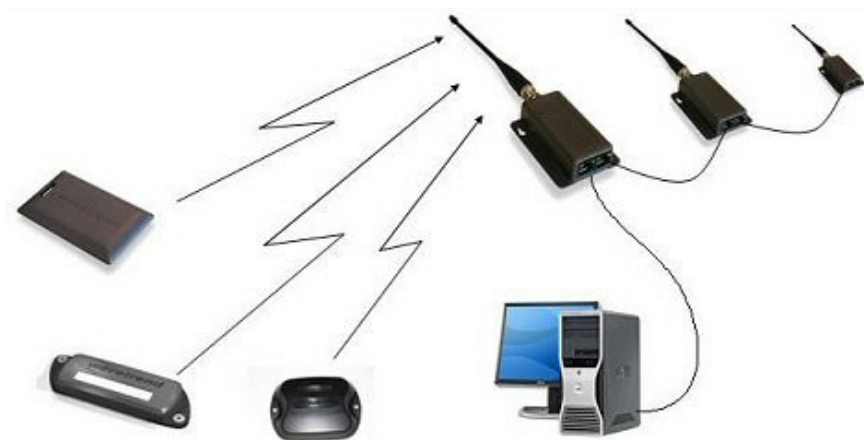
Figura 3. Marcadores, antenas y sistema de gestión.
