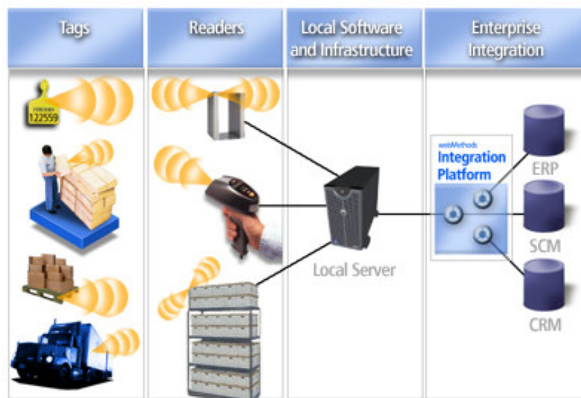
Figura 4. Diagrama de aplicación de un sistema RFID en logística y control de inventario.
