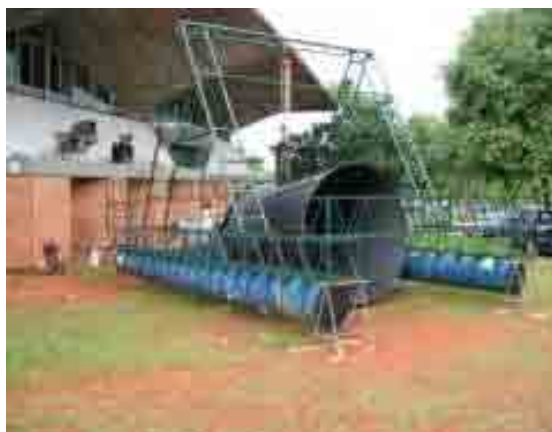
Figura 3. Estructura flotante para sostener la Turbina Hidrocinética en ríos anchos. Fuente: (PCH Notícias & SHP News, N° 26, 2007).
