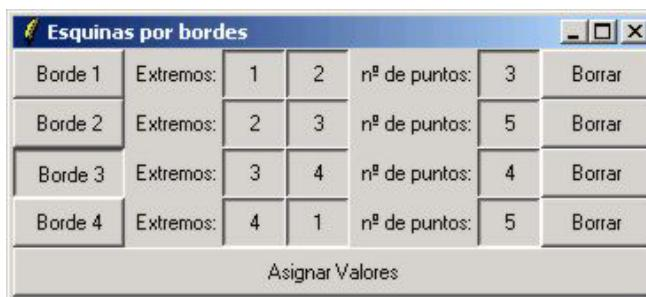
Se requiere un mínimo de tres puntos por borde para definirlo, una vez que se hayan marcado suficientes puntos, se pulsa el botón [Asignar Valores] con lo que las coordenadas de las intersecciones aparecerán en los recuadros correspondientes de la pantalla principal.
