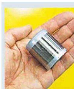
«Una bobina de cinco gramos contiene cinco kilómetros de microhilo»
