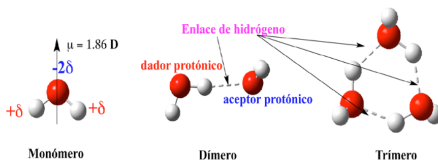
Figura 1. Estructuras del monómero, dímero y trímero de agua. El monómero muestra la distribución de carga y el momento dipolar. El dímero y el trímero están estabilizados por enlaces de hidrógeno. Nótese que en el trímero cada monómero actúa a la vez como dador y como aceptor protónico. Mó, O.; Yáñez, M. and Elguero, J., J. Chem. Phys. 1992, 97, 6628-6638
