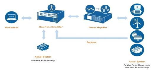
El Departamento de Ingeniería Eléctrica cuenta con un RTDS de la empresa **OPAL-RT**, que se quiere utilizar para **modelar en tiempo real una subestación de distribución**. Este modelo se podrá conectar por medio de un amplificador de potencia al sistema de protección de subestación disponible en el Laboratorio de Sistemas Eléctricos
