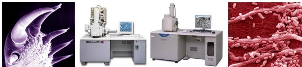
**Hitachi S-4800:** microscopio electrónico de barrido con cañón de emisión de campo (FEG) de cátodo frío (0.5-30 kV), resolución (1 nm a 15 kV, 1.4 nm a 1 kV). Detectores SE in lens, SE low angle y TEM. Tamaño máximo de muestra de 100mm.
