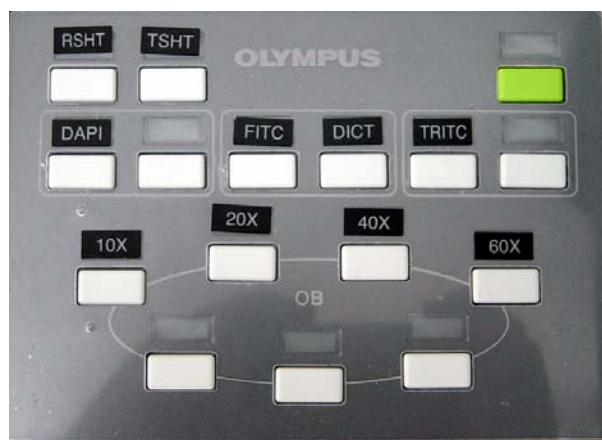
Desde el frontal del microscopio se cambia el modo de enfoque macro o micrométrico (coarse o fine) y el cambio de la ruta óptica de visualización por los binoculares (BI) a modo confocal (LSM), aunque esto también lo hace automáticamente el software.
