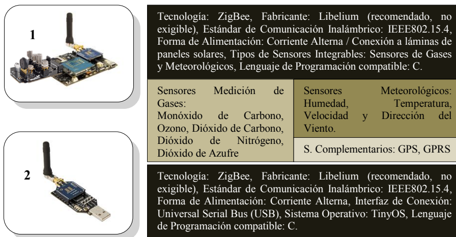
Fig. 2. Características de un 1) nodo terminal y 2) de infraestructura del sistema propuesto.
