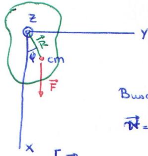
El péndulo físico es un sólido rígido particular que se mueve oscilando alrededor de un eje, a una distancia  $R$  del centro de masas.
