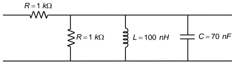
b) Para conseguir un VCO, sustituir el condensador por un diodo varactor de los que aparecen en la siguiente tabla. Elegir uno que permita alcanzar las siguientes especificaciones del VCO:
