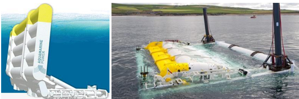
Figura (4): WEC Oyster 800. Detalle del equipo (izquierda) e imagen de la instalación en el mar (REUK, 2020).
