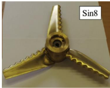
Figura (1): Izquierda: Imagen del rotor de una turbina tidal (Shi, Atlar and Norman, 2017) y Derecha: aleta de una ballena jorobaba (SMYTH, 2016).
