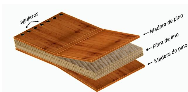
Figura 1. Configuración del laminado tipo FWL
