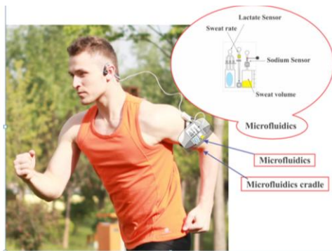
Figura 1: Concepto de dispositivo microfluídico llevable “wearable”.
