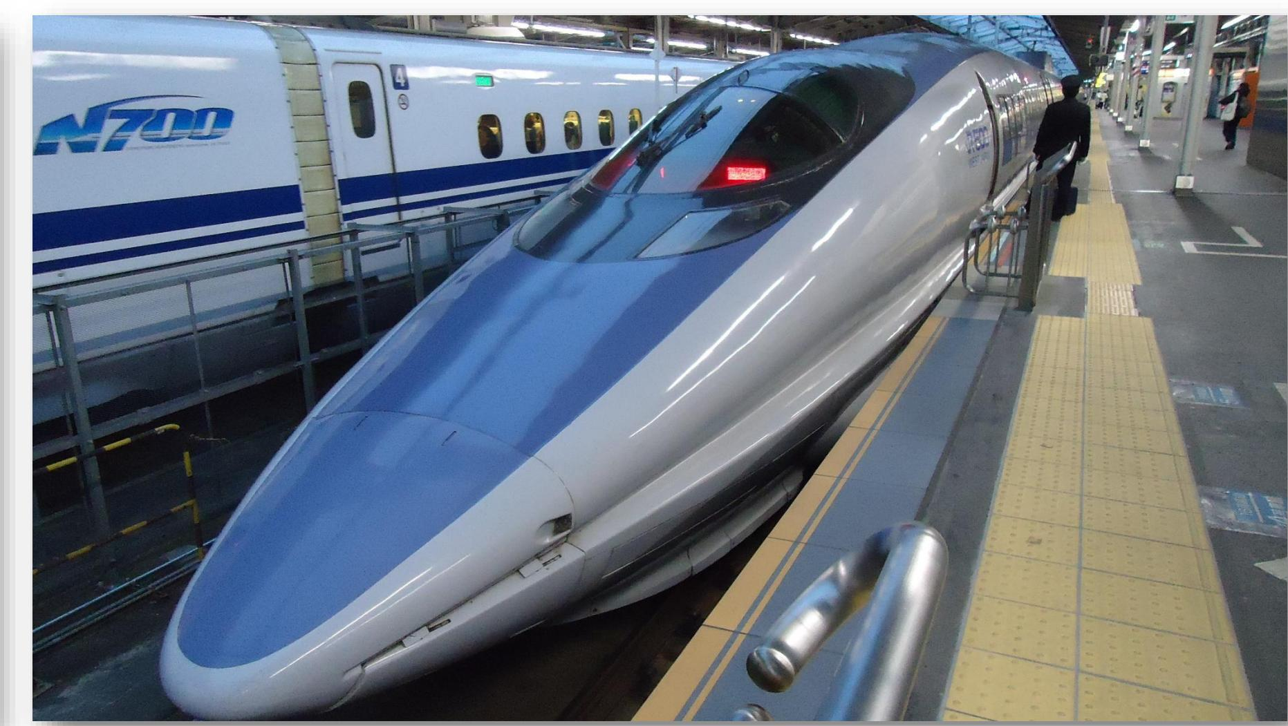
Tren diseñado para alcanzar 350 km/h se veía obligado a disminuir su velocidad a 250 km/h al pasar por un túnel debido al cambio de densidad del aire entre el interior y el exterior. Para solventar el problema los ingenieros se inspiraron en la morfología del pico del martín pescador (*Alcedo atthis*).
