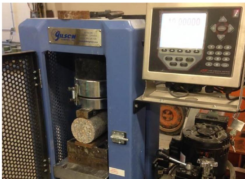
Figura 35. Ensayo de resistencia a tracción indirecta [12].
