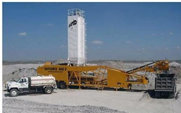
Figura 3. Mezclador de flujo continuo [17].
