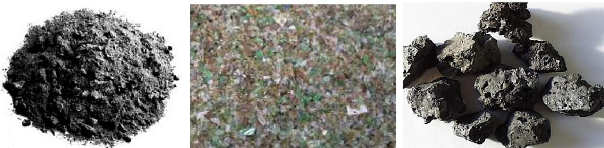
Figura 27. Materiales reciclados utilizados en morteros y hormigones como sustitución de los áridos naturales. De izda. a dcha.: cenizas de fondo, vidrio reciclado y EAFS [44, 64, 68].
