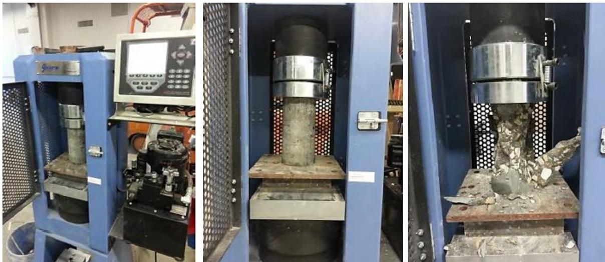
Figura 33. Ensayo de resistencia a compresión [12].
