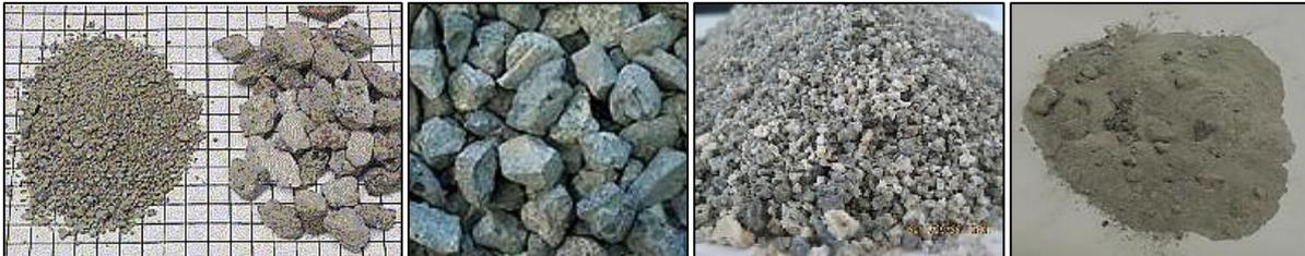
Figura 19. Escorias de la fabricación del acero: BFS, LDS, EAFS y LFS (de izda. a dcha.).
