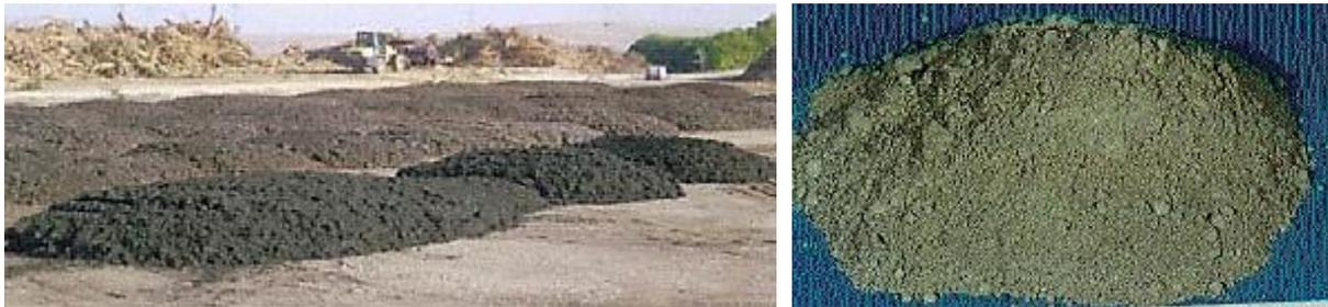
Figura 28. Materiales reciclados utilizados en morteros y hormigones como adición del cemento: lodos de depuradora de aguas residuales (izda.) y humo de sílice (dcha.) [75, 76].
