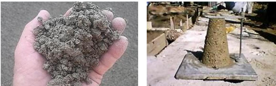
Figura 1. Aspecto (Izda.) y consistencia (Dcha.) del HCR [7].
