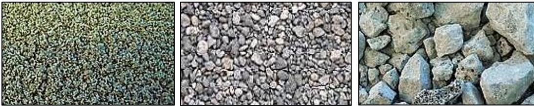
Figura 17. Escorias de horno alto (BFS): granuladas, expandidas/peletizadas y enfriadas al aire (de izda. a dcha.) [34, 35].
