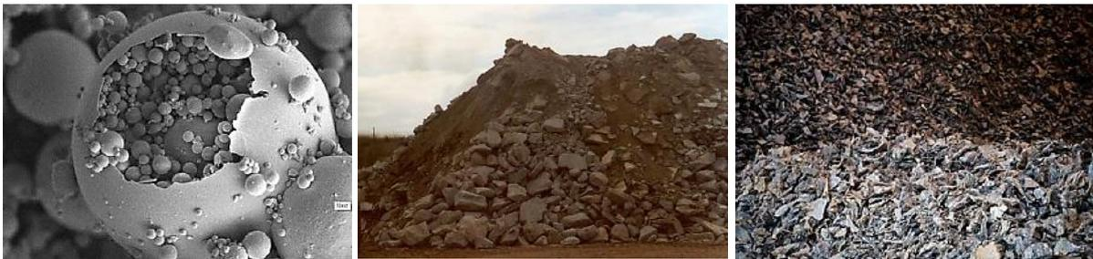
Figura 26. Materiales reciclados utilizados en morteros y hormigones como sustitución de los áridos naturales. De izda. a dcha.: cenizas volantes, RCD y NFU troceados [56, 57, 61].
