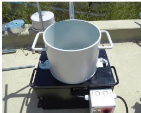
Figura 37. Consistómetro Vebe empleado para evaluar la consistencia de mezclas de HCR en estado fresco [12].
