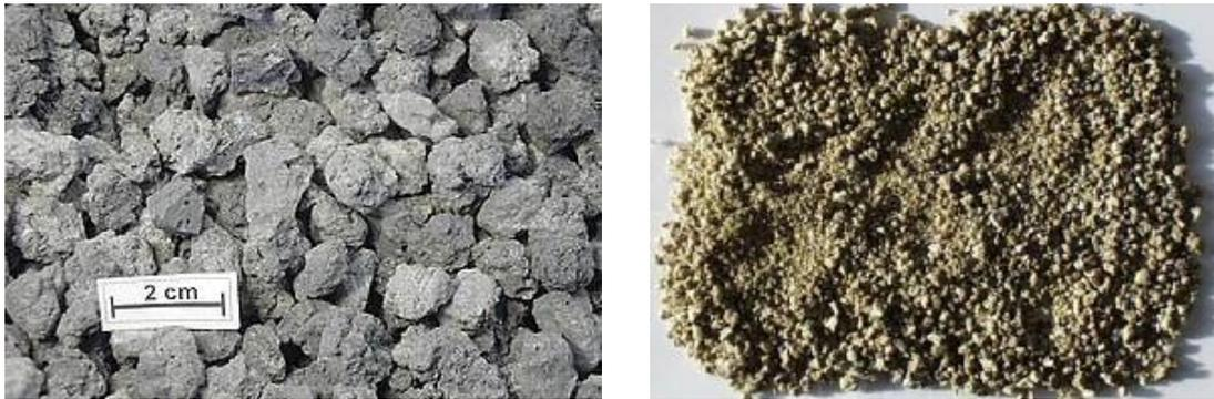
Figura 20. Escorias de horno eléctrico de arco: EAFS (izda.) y LFS (dcha.) [33, 35].
