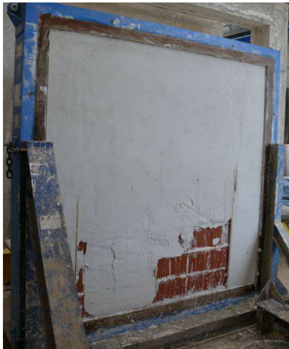
Figura 5– Aplicación del revestimiento y medición del mismo
