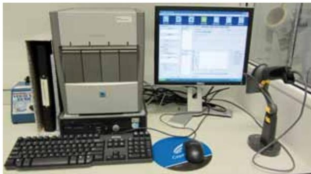
Fig. 12: Plataforma GeneXpert® de PCR en tiempo real. Se está procesando una muestra clínica para la detección de *M. tuberculosis* y resistencia primaria a la isoniazida en un cartucho comercial.
