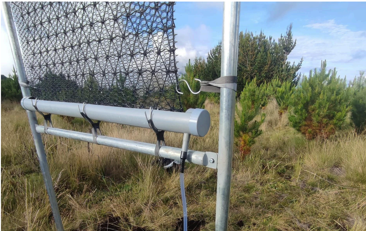
Figura 5.9. Fotografía del detalle de los ganchos y la canaleta. Imagen de elaboración propia.
