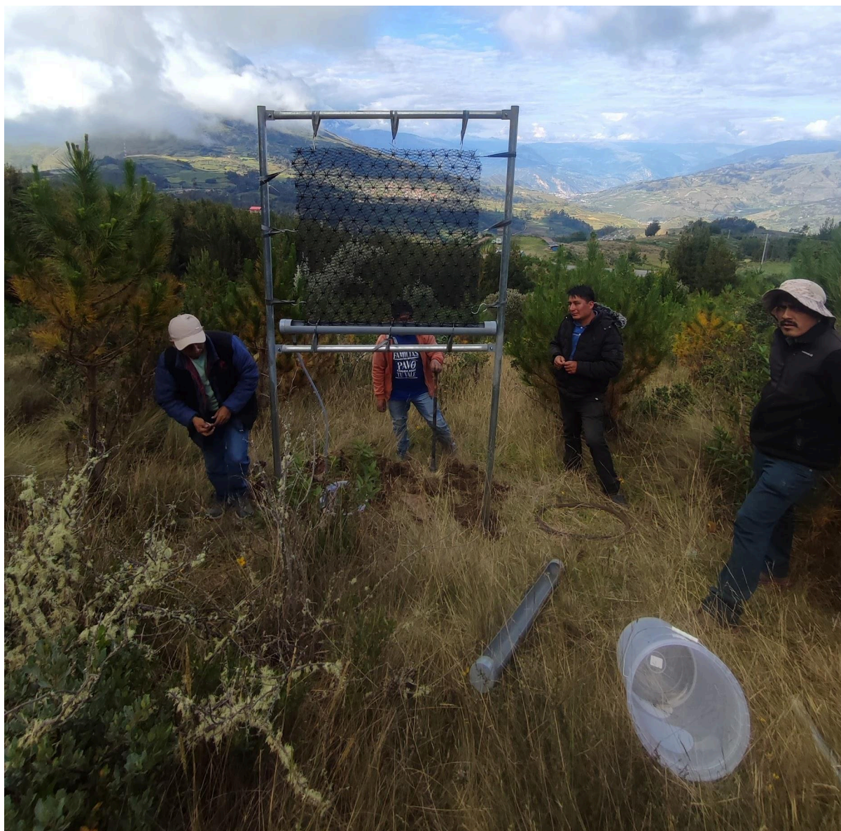
Figura 6.5. Fotografía de la instalación de un neblinómetro en Concacha. Imagen de autoría propia.
