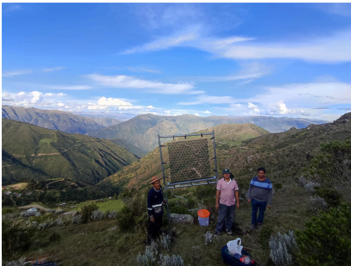
Figura 6.7. Fotografía de la instalación de un neblinómetro en Pucuta. Imagen de autoría propia.
