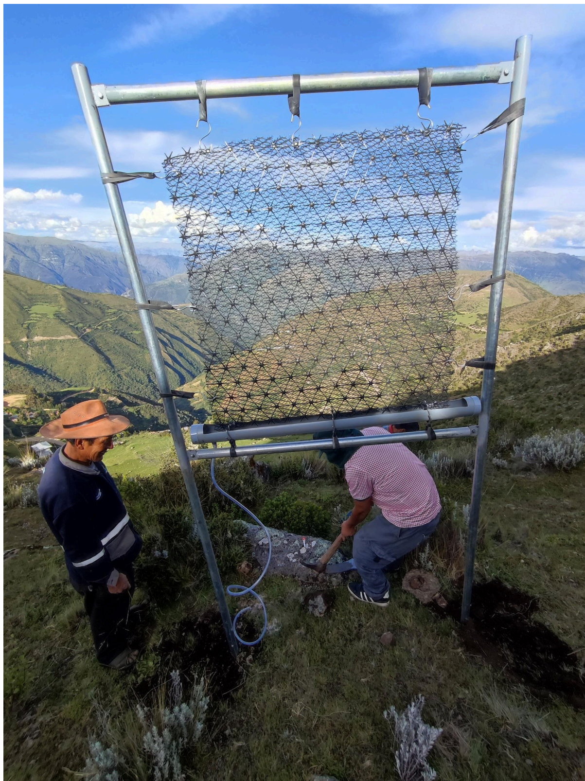
Figura 6.9. Fotografía de la instalación de un neblinómetro en Pucuta. Imagen de autoría propia.
