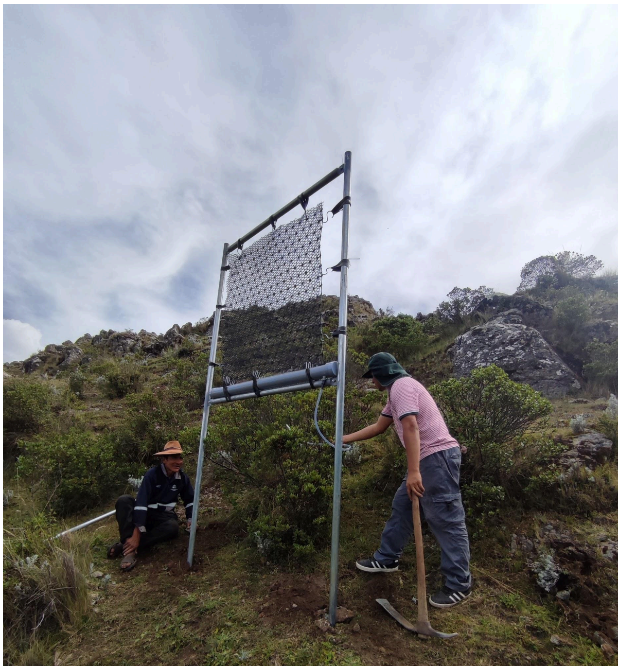
Figura 6.8. Fotografía de la instalación de un neblinómetro en Pucuta. Imagen de autoría propia.
