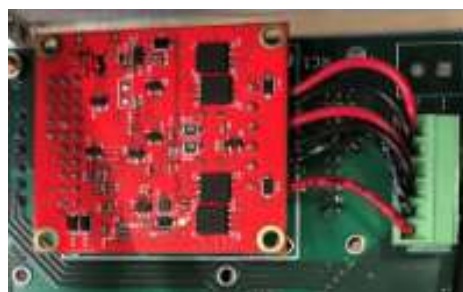
Ilustración 19: A la izquierda, Roboclaw 2x7A Motor Controller [54]. A la derecha, el controlador serie colocado en el robot.
