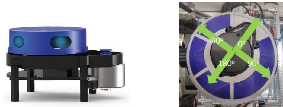
Ilustración 16: A la izquierda, el LiDAR VDLIDAR X4 [49]. A la derecha, la regla de la mano izquierda sobre el dispositivo físico.
