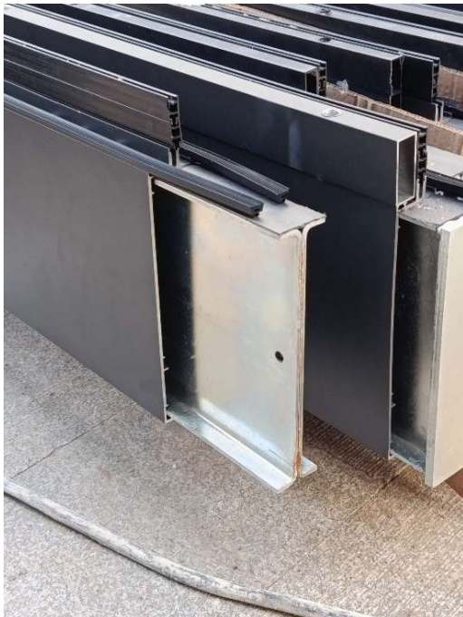
Figura 43. Refuerzo de perfiles muro cortina con acero.
