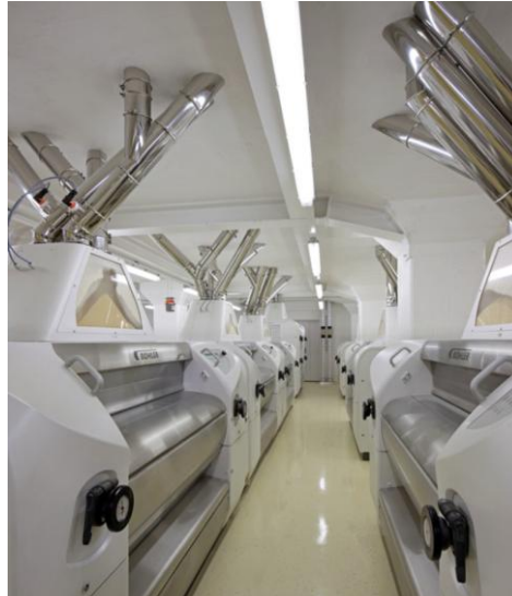
Figura 17. Molinos de Rodillos en la Industria de la Molienda de Trigo. Fuente: Proceso productivo. AFHSE (s.f.)
