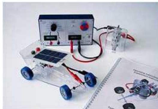
4. Irudia. Erregai-pilan oinarrituriko ibilgailu baten moduluak.
