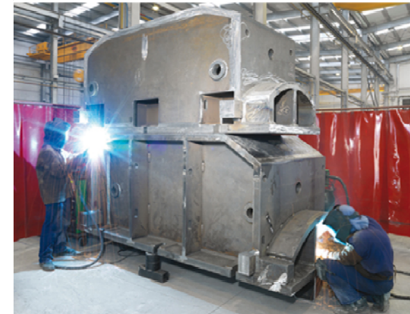
EGONDO, soldadura en elemento estructural para maquinaria pesada
