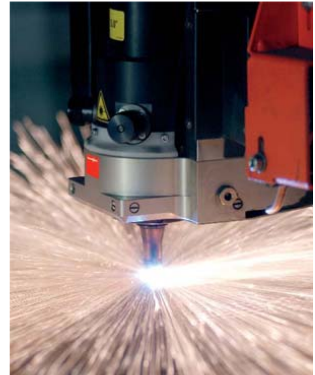
Corte por láser de chapa
