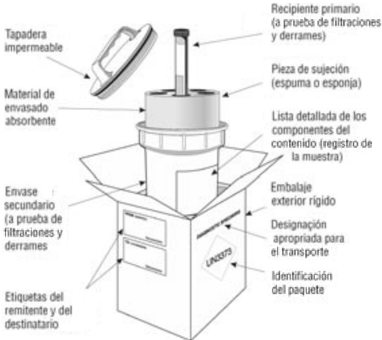
Figura 11. Ejemplos de sistemas de embalaje/ensado triple (Ilustraciones amablemente cedidas por la IATA, Montreal (Canadá))
